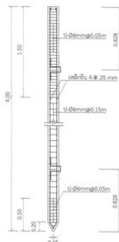
รายละเอียดเสาเข็ม R/C ขนาด 0.26x0.26x4.00 m
