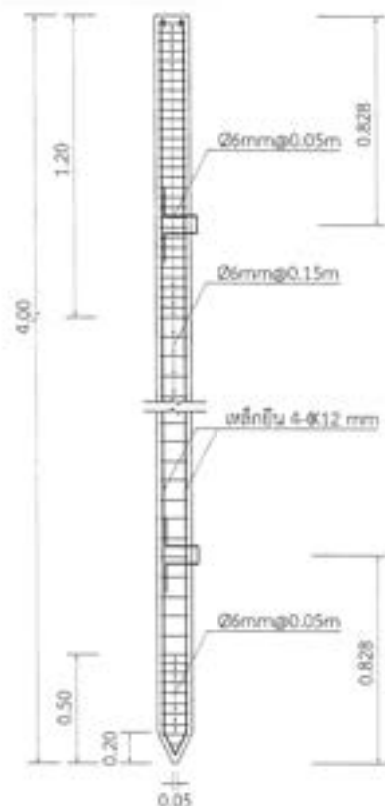
รายละเอียดเสาเข็ม R/C ขนาด 0.15x0.15x4.00 m
