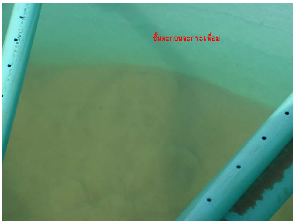
รูปที่ 16 แสดงลักษณะตะกอนด้านบนเกิดการกระเพื่อม
