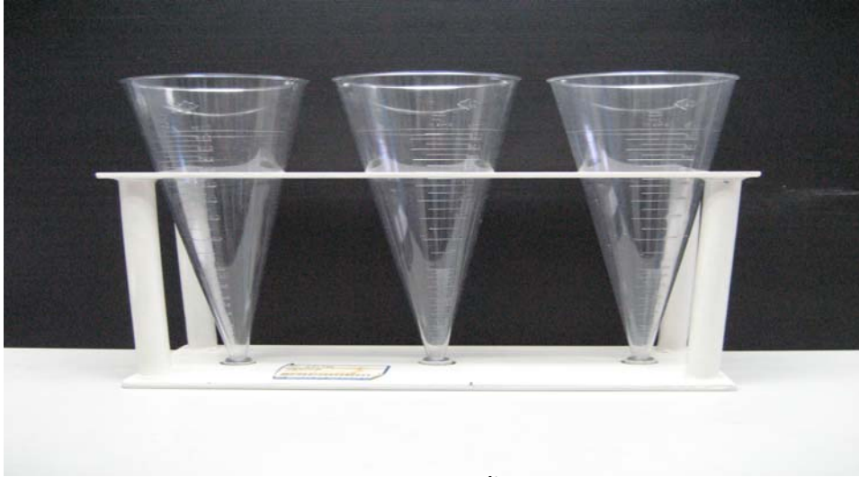
รูปที่ 13 แสดง Imhoff Cone สำหรับการตกตะกอนของชั้นตะกอนในระดับต่างๆของถัง Pulsator
